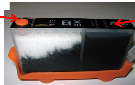
Расположение заправочных и воздушных отверстий в картриджах ПЗК
